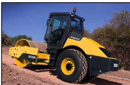
El compactador de rodillos es una máquina autopropulsada o remolcada sobre ruedas o rodillos, diseñada para aumentar la densidad del material por peso estático, impacto, vibración, amasado (presión dinámica) o combinación de estos efectos.
