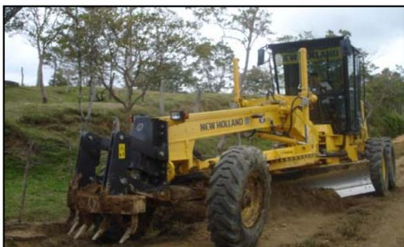
La motoniveladora es una máquina autopropulsada de neumáticos, equipada de una hoja regulable situada entre los ejes delantero y trasero. En la parte trasera puede llevar un riper.
