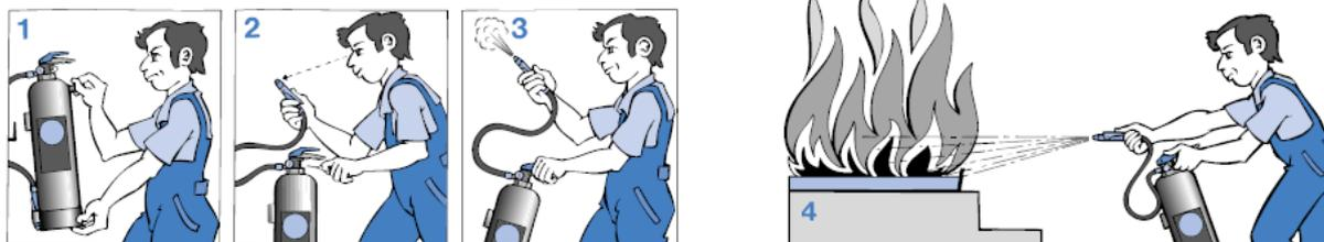
1-2-3) Descolgar el extintor, asiéndolo por la maneta o asa fija y dejarlo sobre el suelo en posición vertical. Quitar el pasador de seguridad tirando de su anilla. Realizar una pequeña descarga de comprobación de salida del agente extintor.
