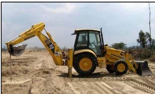
La pala mixta es un vehículo móvil sobre ruedas, utilizado tanto para trabajos de excavación como de carga de materiales al disponer de una pala de carga en su parte frontal y de una cuchara en su parte posterior.
